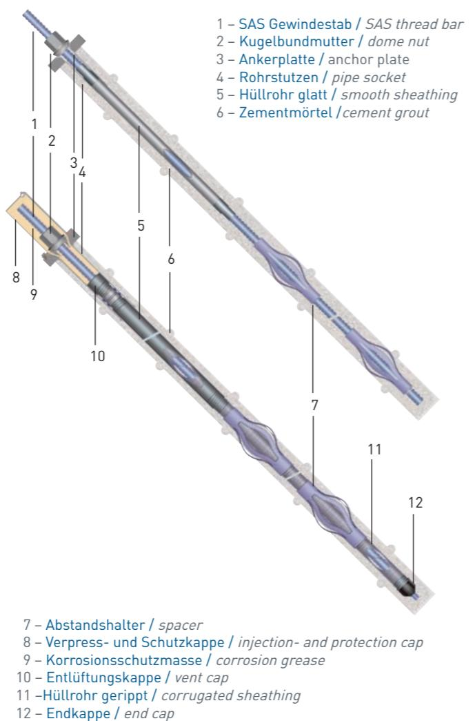
Aufgrund unserer hohen Vielfalt an Stahlqualitäten und Durchmessern können unsere SAS Ge- windestahl-Systeme optimal die Anforderung der verschiedenen Zugstabkonstruktionen erfüllen und sind zugleich eine einfache und wirtschaftliche Lösung.
