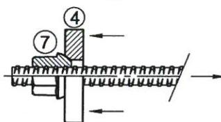
Geschraubte Muffenverbindungen und Verankerungen von Stabstahl mit Gewinderippen SAS 555/700, Nenndurchmesser: 57,5 und 63,5 mm
